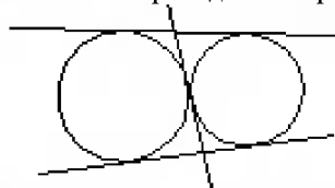
Рис. 27. Окружности, касательные к трем отрезкам
